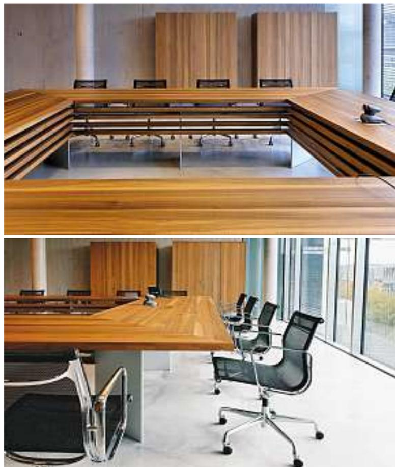
Bild nächste Seite: Hufeisenförmige Konferenztischanlage in Wengé massiv. Unter dem flächenbündig im Tisch eingelassen Band in Aluminium verbergen sich die Medienschnittstellen und hochfahrbare Monitore für die Konferenzteilnehmer. Untergestell und Sichtblende im Knieraum in Aluminium natur eloxiert.
